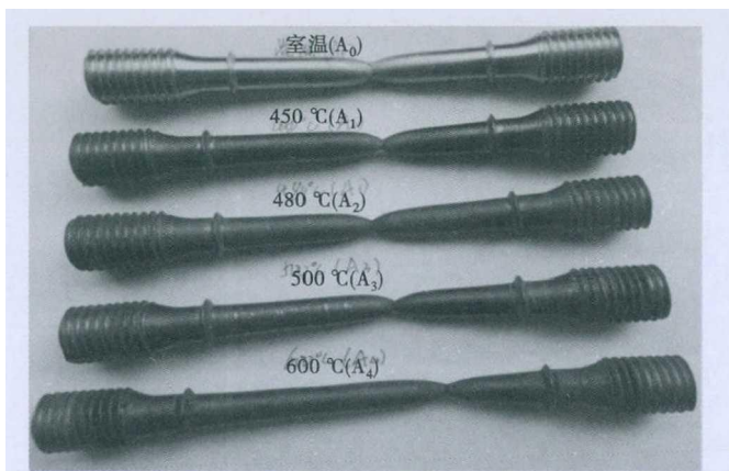
图 1 EH420 钢室温 ( A_0 ), 450 °C ( A_1 ), 480 °C ( A_2 ), 500 °C ( A_3 ), 600 °C ( A_4 ) 拉伸试样断裂形貌
